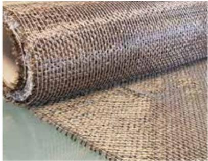
A1 Triaxial basalt fibre 160 gr/m<sup>2</sup>
