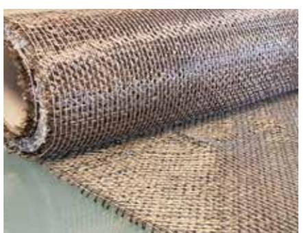
A1 Triaxial basalt fibre 160 gr/m<sup>2</sup>
