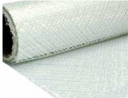
A1 Triaxial glass fibre 160 gr/m<sup>2</sup>
